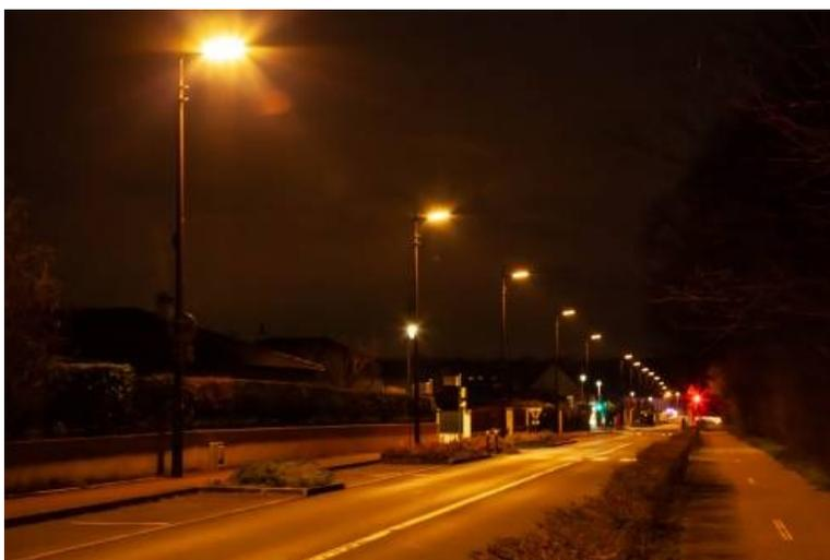
Les nouvelles lanternes des candélabres offrent un éclairage à la fois côté rue et côté forêt, doté d'une teinte LED adaptée pour déranger le moins possible les diverses espèces. La température de couleur des lampes, autrefois autorisée jusqu'à 4 000K, est désormais revue à la baisse et réglée à 2 700K tirant sur les tons jaunes orangés.
