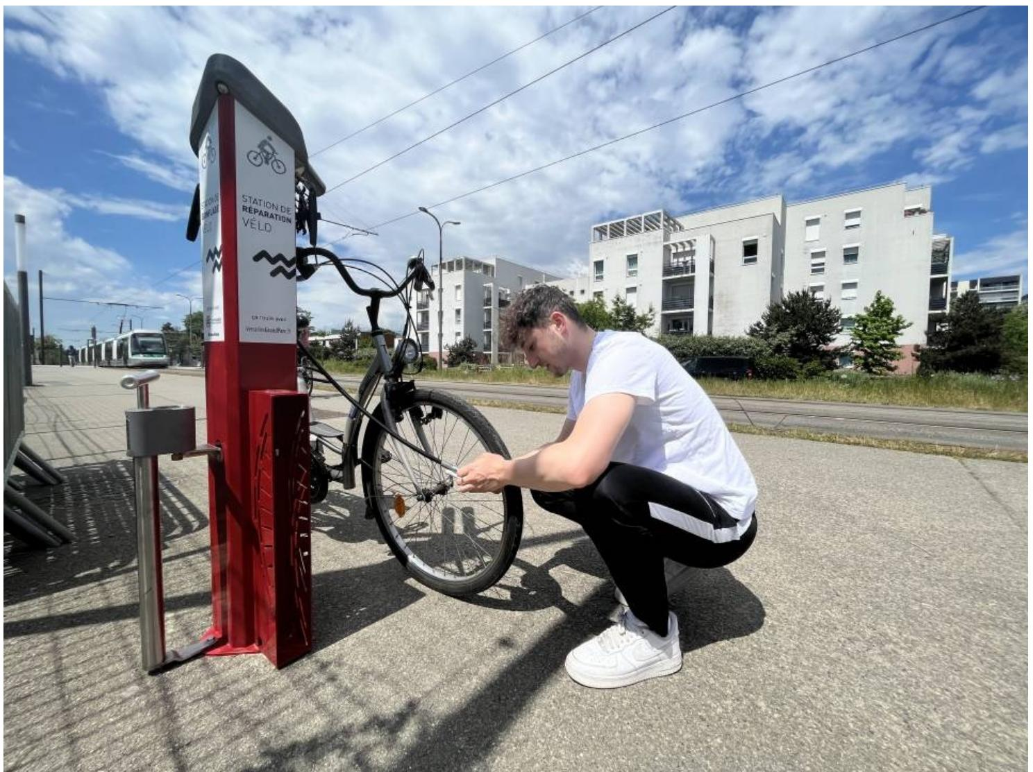
Clés, tournevis, gonfleur, ou encore démonte-pneus ? les bornes de gonflage et de réparation mettent à disposition des cyclistes tout le nécessaire pour entretenir un vélo ou faire de petites réparations express ! Un dispositif pratique et ingénieux.
