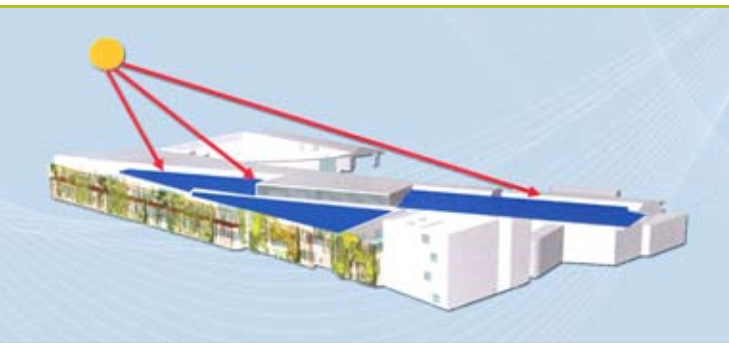
Production d'énergie par 460 m² de capteurs photovoltaïques.
